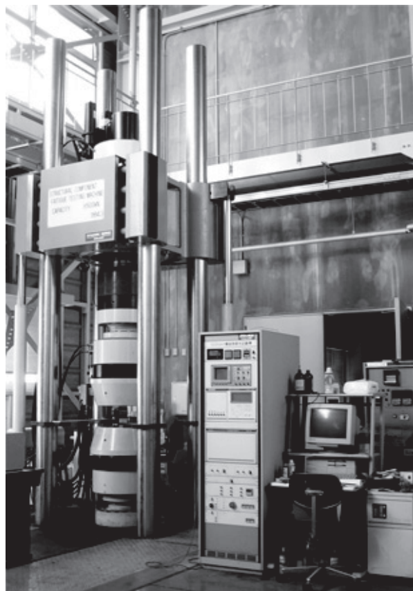
図 3 油圧サーボ疲労試験機 (容量 1500kN)
