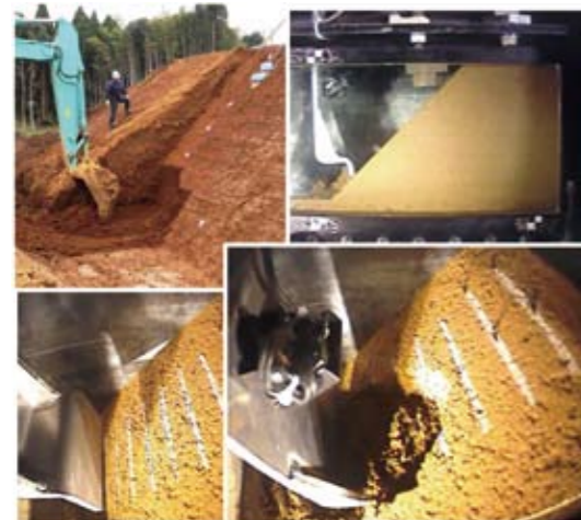
斜面崩壊を再現する実験の様子
