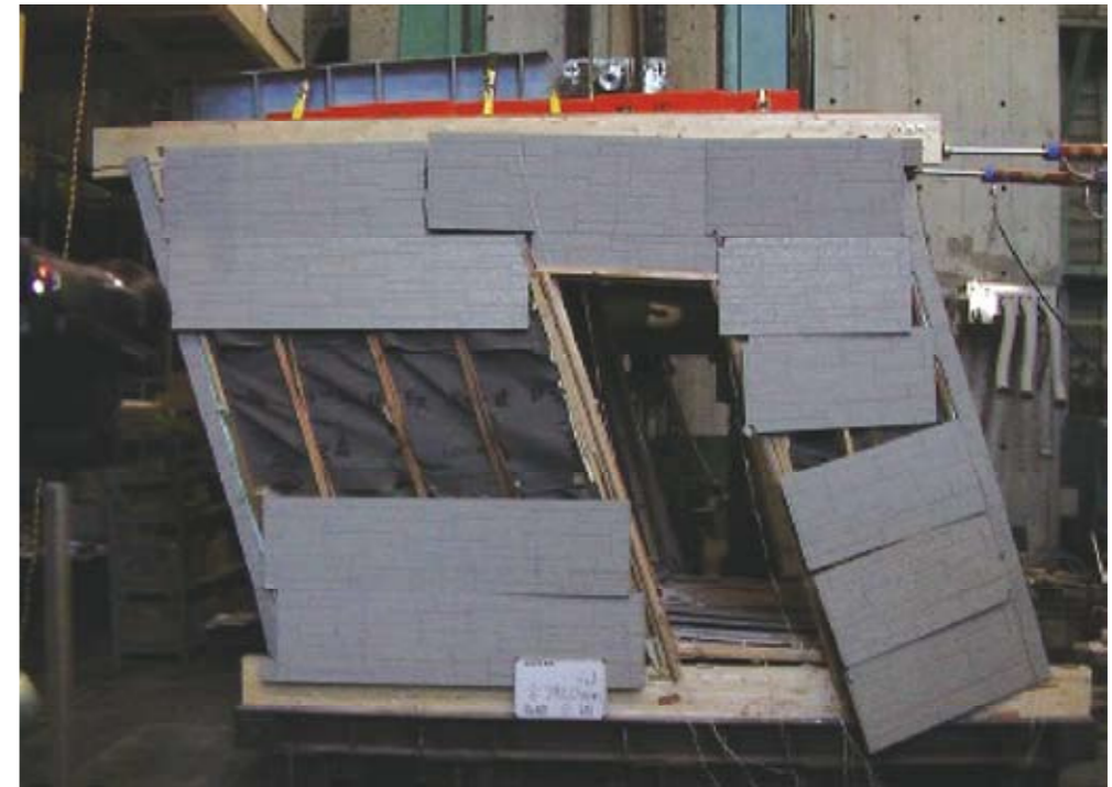
大破壊した実大木造家屋模型（6 畳）
