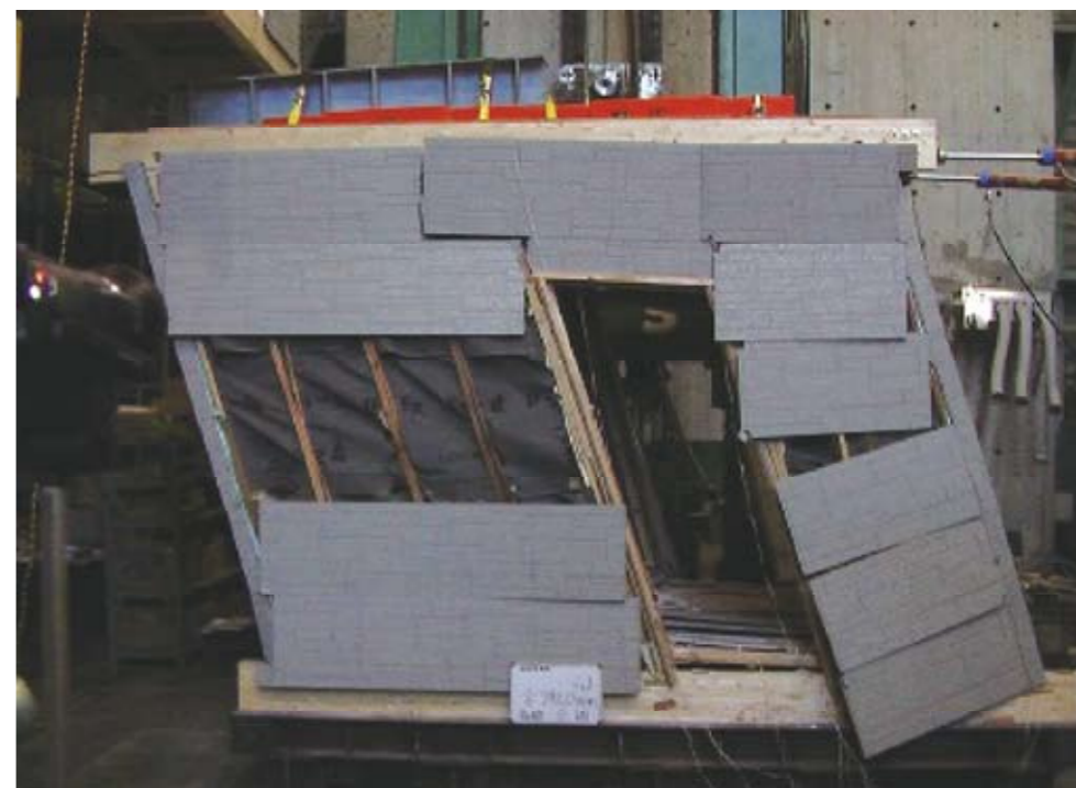
大破壊した実大木造家屋模型（6畳）
