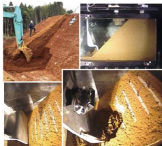
斜面崩壊を再現する実験の様子
