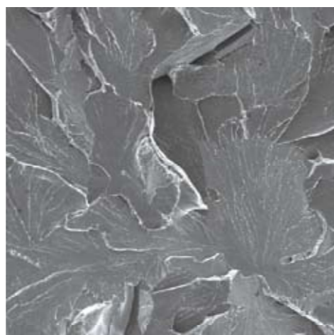
材料が脆くなって破壊した例
