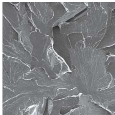
材料が脆くなって破壊した例
