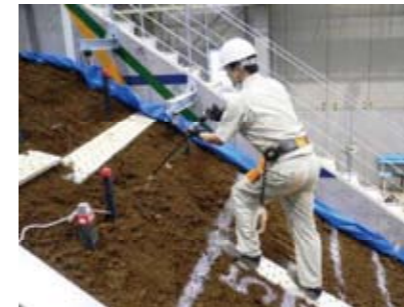
計測用センサーの設置
