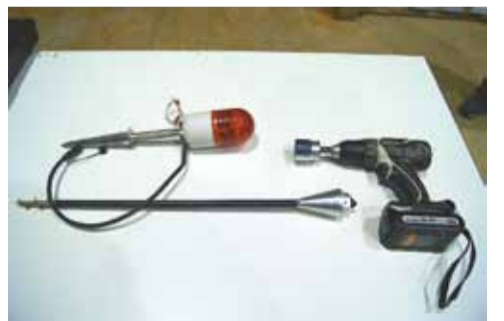
設置・使用が容易にでき、土砂崩壊から作業員などの労働者の安全を守る「表層ひずみ棒」
