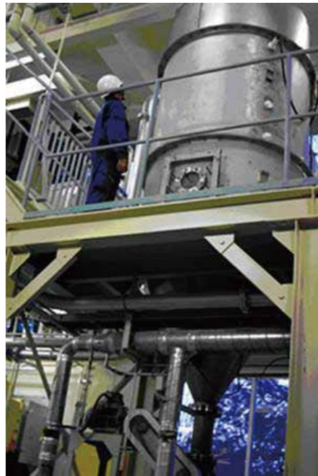
写真1 実規模粉体空気輸送実験装置
