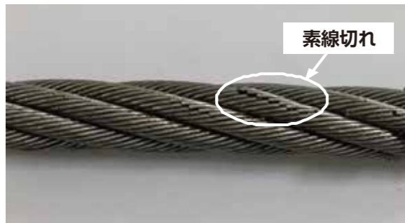
写真1 ワイヤロープの劣化
