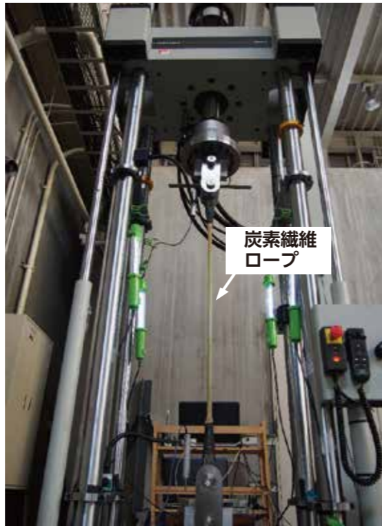
写真3 炭素繊維ロープの劣化実験
