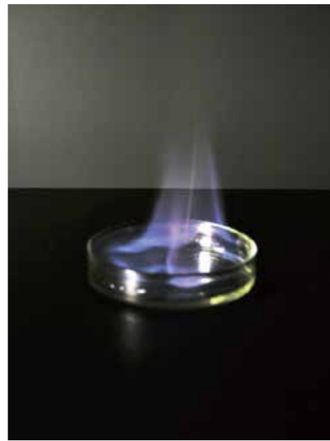
写真2 有機溶剤蒸気の燃焼 (火災)
