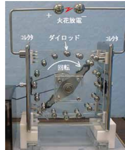
写真1 静電誘導を応用した発電装置
