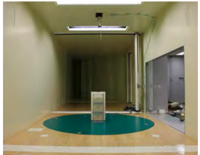
写真2 足場模型を用いた風洞実験
