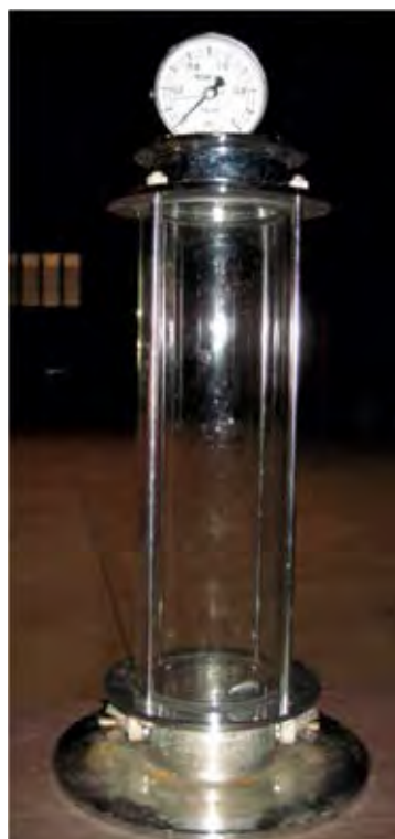
写真2 ガス・蒸気爆発デモ装置
