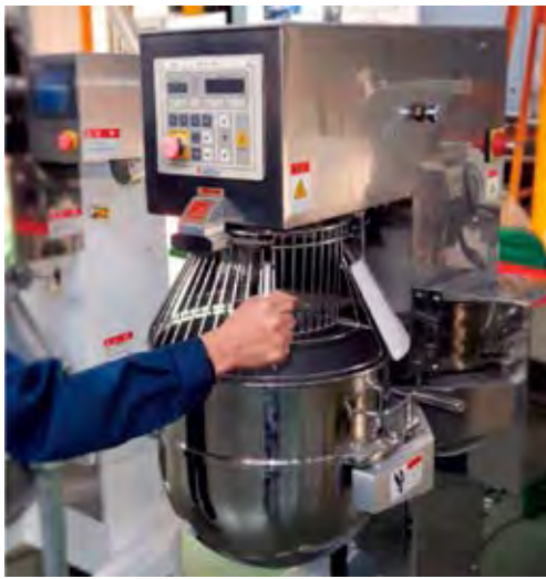
写真1 インターロックガードを備えたミキサー
