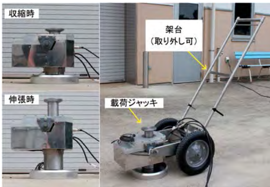
写真1 現場地耐力試験装置
