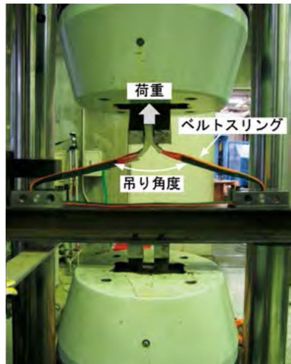
写真2 ベルトスリングの破断実験
