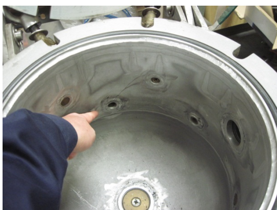
写真 真空容器（指で示したところの上に長方形の穴を開ける予定）
