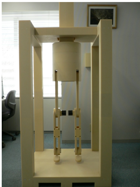
写真 1: 昨年度に作製した樹脂製ダミー (エンコーダには導電性の部材が使用されている)
