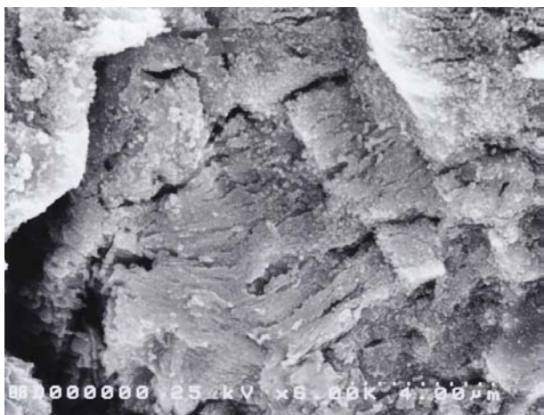
ブーム破断面で観察されたストライエーション模様 （電子顕微鏡写真）
