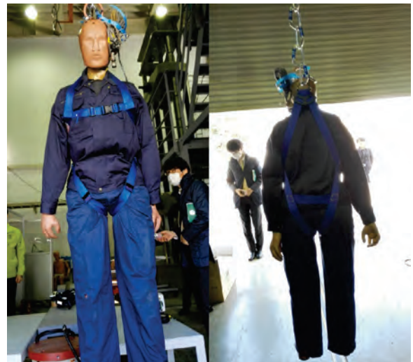
図3 腿ベルトがV型のハーネス型安全帯 (適切に着用した場合)
