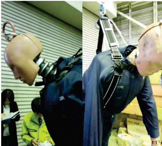
図6 腿ベルトが水平型のハーネス型安全帯 (緩めに着用した場合)
