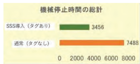
図4 機械停止時間: 8時間の作業時間内に停止する時間(秒)。SSS 導入条件(上)と非常停止条件(下)
