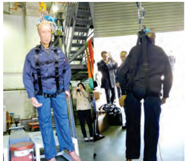
図4 腿ベルトが水平型のハーネス型安全帯 (適切に着用した場合)
