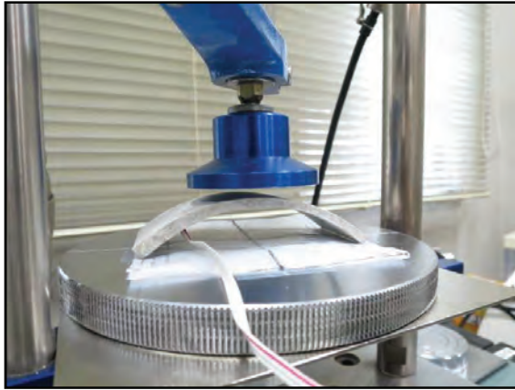
(a) セグメント模型単体曲げ実験の様子
