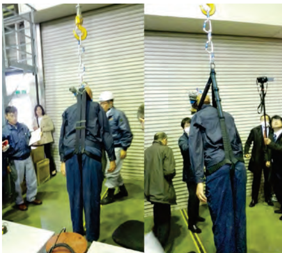
図7 腿ベルトが水平型のハーネス型安全帯 (緩めに着用した場合)
