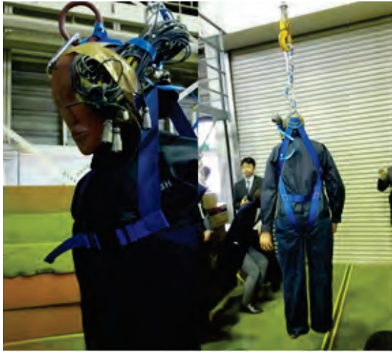
図5 腿ベルトがV型のハーネス型安全帯 (緩めに着用した場合)
