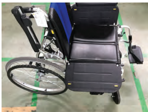
図15 自走向け車いすのタイヤ後方スライド機構
