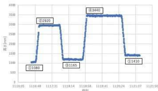
図 2 実験 14 の可視光通信システムの高さ測位結果
