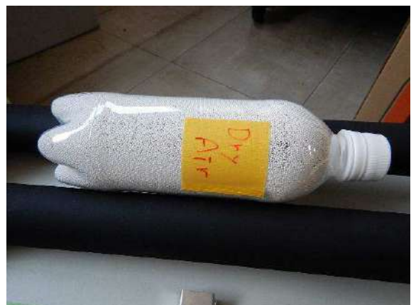
図 4 乾燥空気を封入して攪拌した結果
