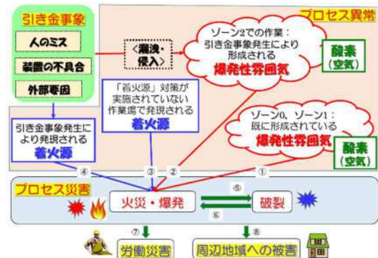
図2 火災・爆発発生のパターンと労働災害・事業場周辺地域への被害の拡大
