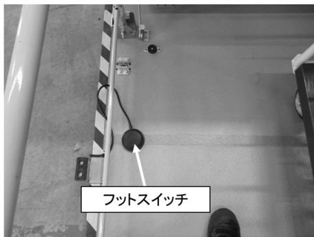
図6 デッドマン方式の昇降制御フットスイッチ
