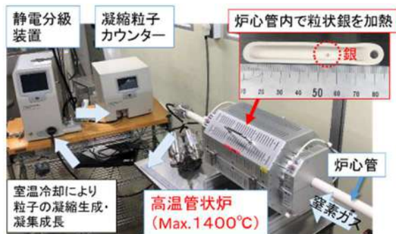
図 1 蒸発凝縮式エアロゾル発生システム。 本研究では、銀ナノ粒子凝集体の発生装置 として使用。
