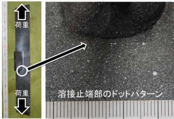
図12 溶接試験片における計測位置
