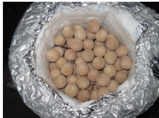
図 1 燃焼容器に試料を堆積した様子(木球、直径 25mm)
