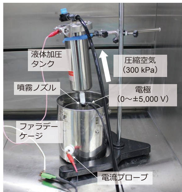
図 1 噴霧帯電量測定用実験装置
