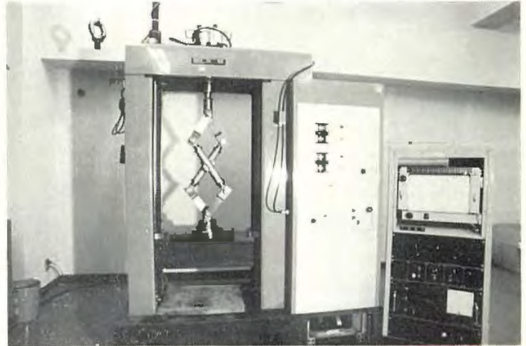
万能型引張試験機 (足場用クランプの曲げ剛性試験)
