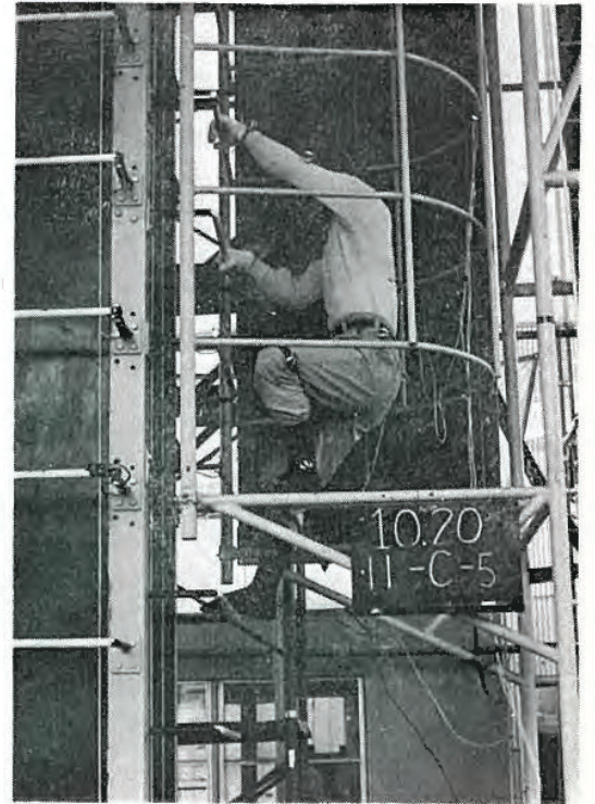
シャフト内梯子の昇降実験
