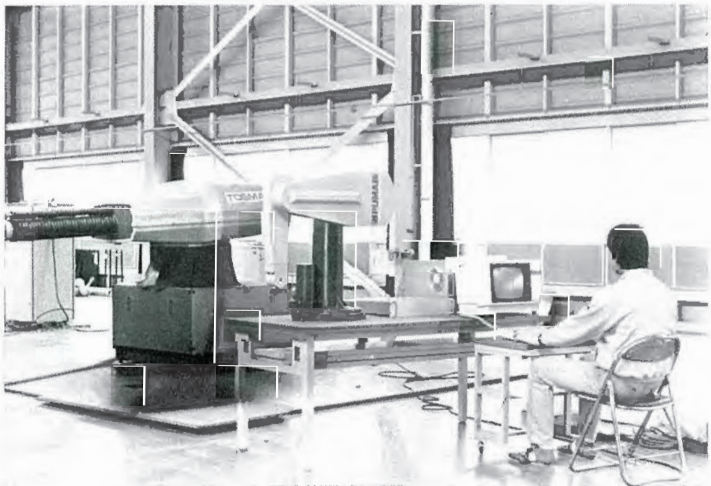
スポット溶接用ロボットの防護計測技術の運用のための実験
