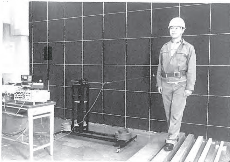
足場板上での作業における平衡機能の実験
