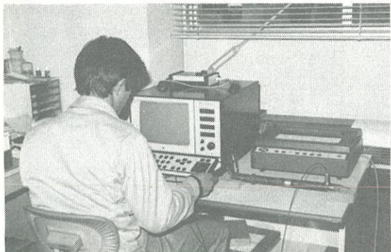
防振型チゼルの制振性能測定
