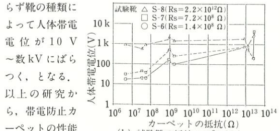
(b) 試験靴の抵抗: 10^8\Omega 以上
