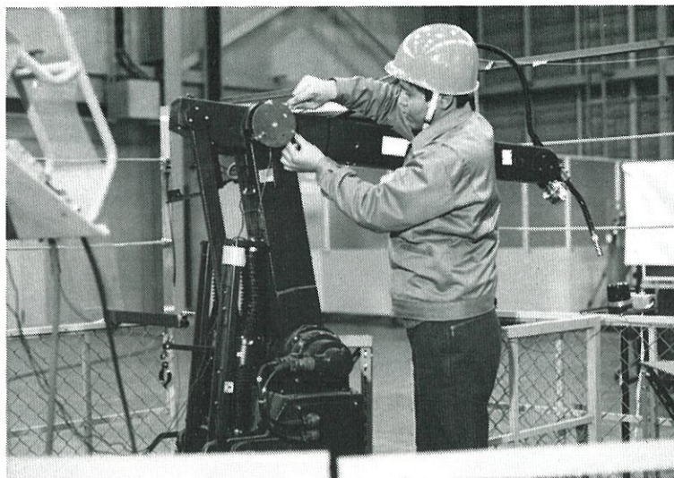
メカウインドウスイッチによるロボットの不意起動の防止実験
