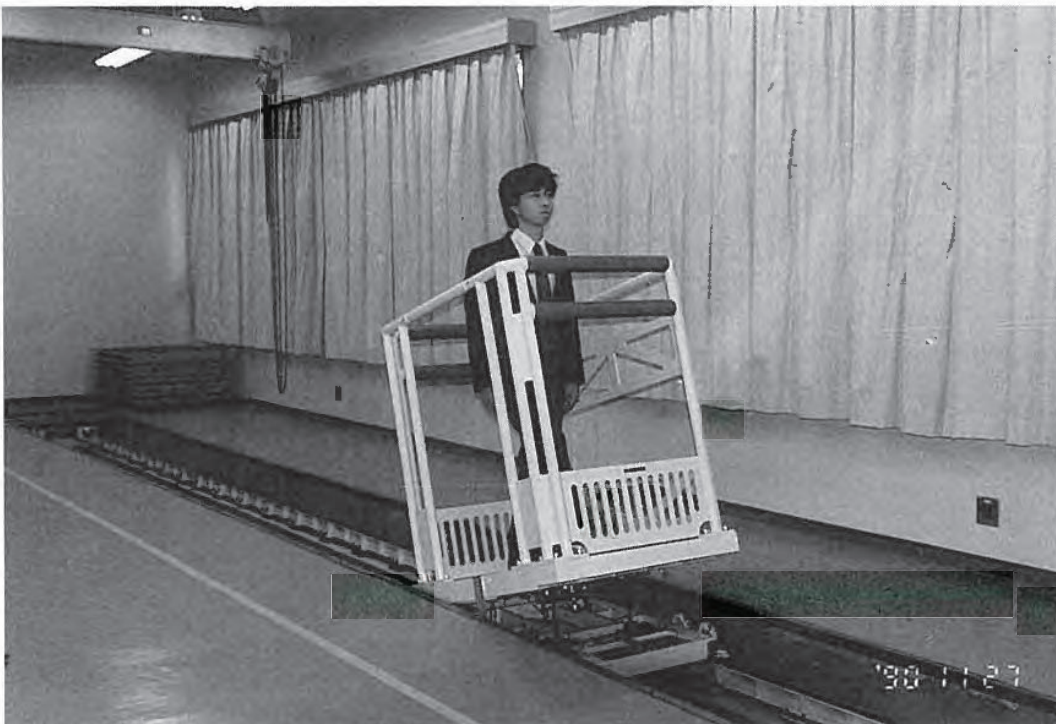
環境安全実験棟主要実験設備 (転倒耐力測定装置による起立能力測定)
