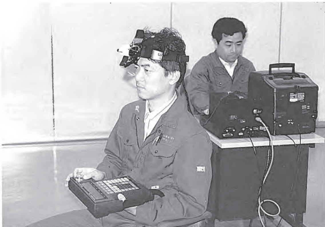
高所作業における人体特性の研究に用いる 注視点検出装置（アイカメラ）
