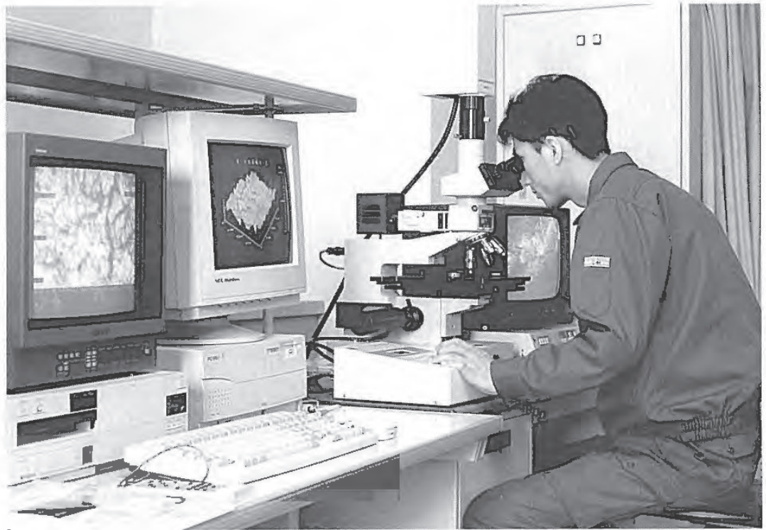
物体表面の微細な凹凸状態を高精度で計測するためのレーザー顕微鏡
