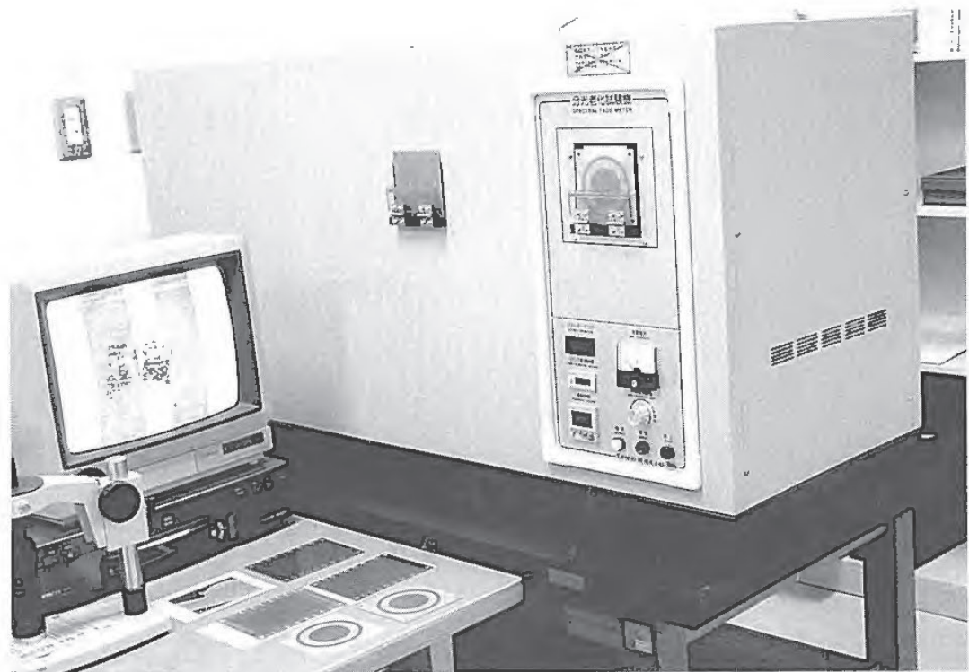
紫外線による電気絶縁物の劣化の研究に用いる紫外線照射試験装置
