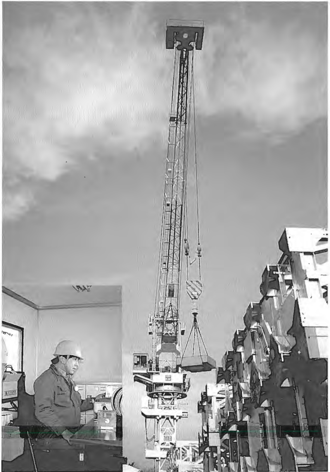
クレーンの振動特性に関する現場実測試験の実施状況 (労働省特別研究)
