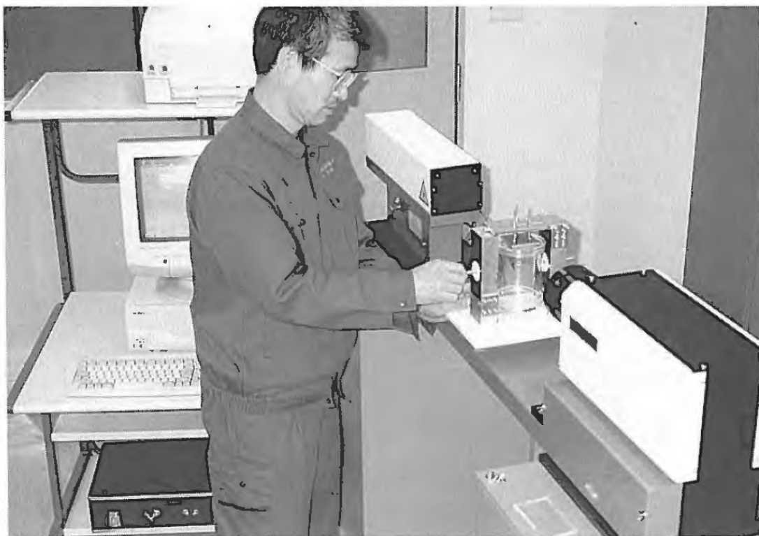
可燃性ミストの静電気着火危険性の研究に用いる 噴霧粒度分布測定装置
