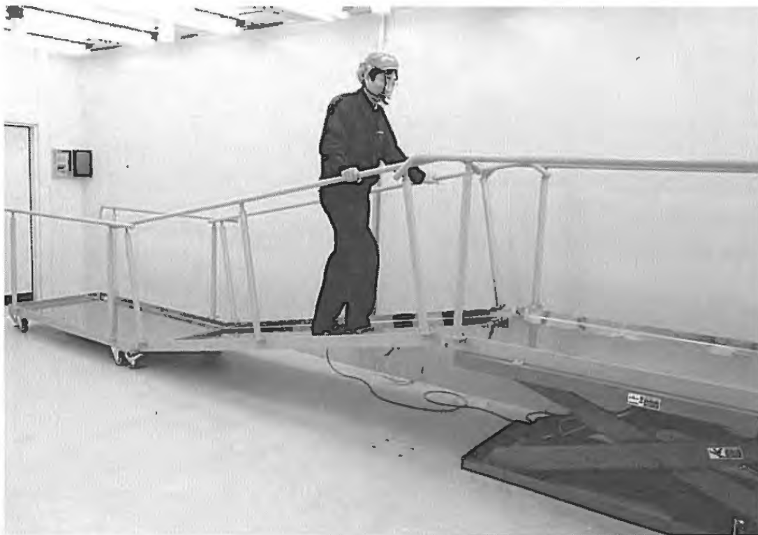
傾斜作業面での滑りの研究に用いる滑り試験装置
