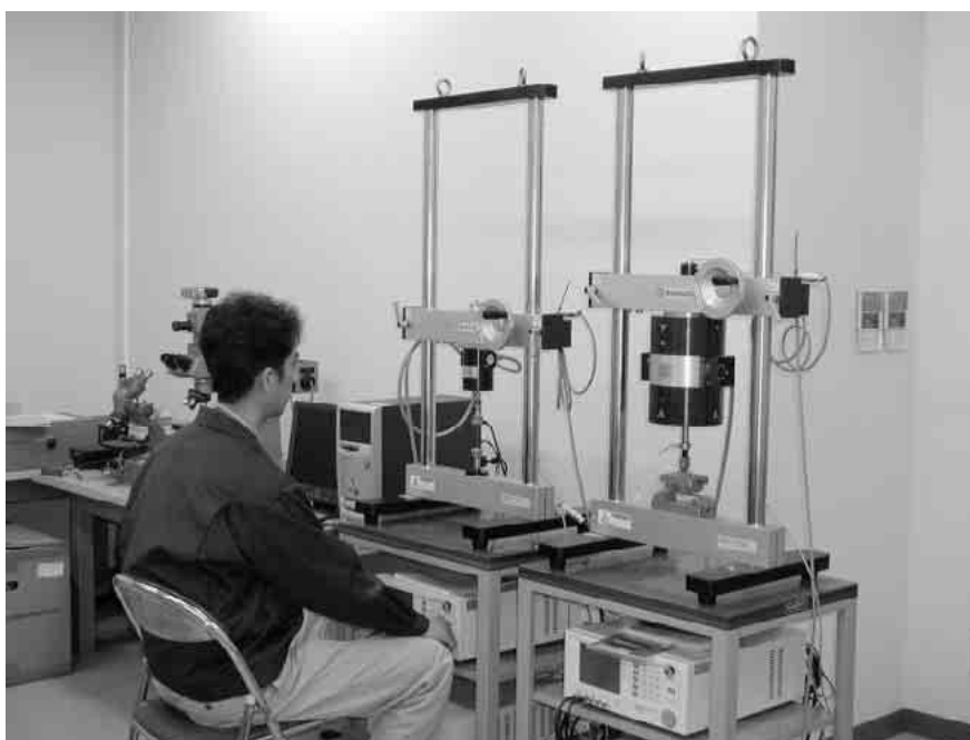
小型試験片の高サイクル疲労試験に用いる微小材料試験システム
