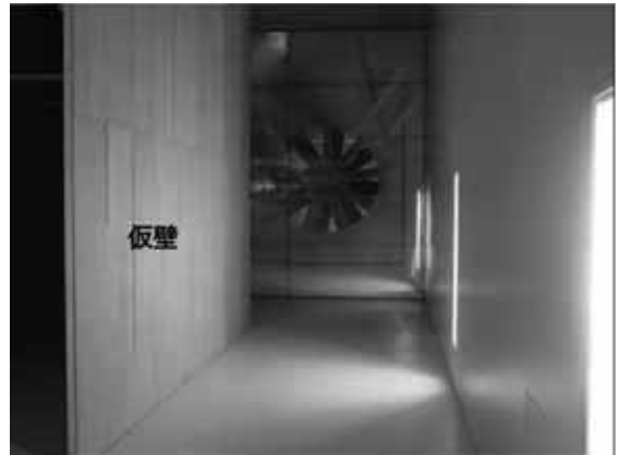
写真1 第2測定胴に設置した仮壁
