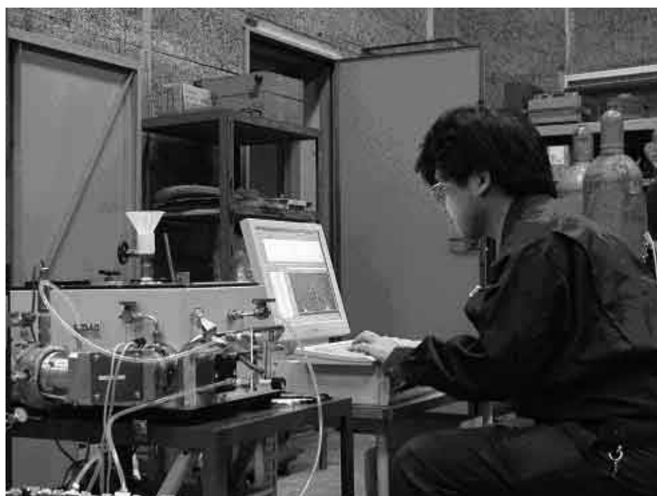
ガスモニター測定装置（物質の反応・爆発現象の解明，災害原因物質の調査等に活用）
