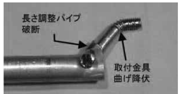
写真2 最終破壊状況例
