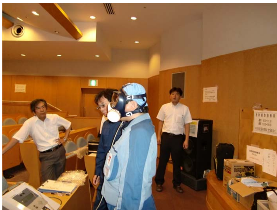
写真 4. 眼鏡着用者にシールピースを使用してもらい、漏れ率の改善状況を把握するため、再度フィットネステストを実施した。
