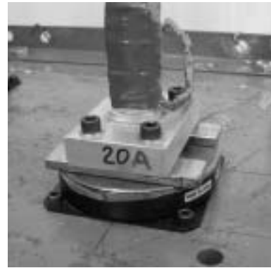
Fig. 4 Electromagnetic brake 電磁ブレーキ設置状況
