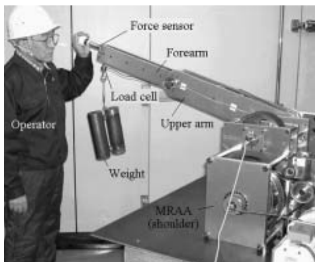
Photo 4 Experiment of cooperative material handling using experimental robot arm. 実験用アームを用いた協調運搬作業実験
