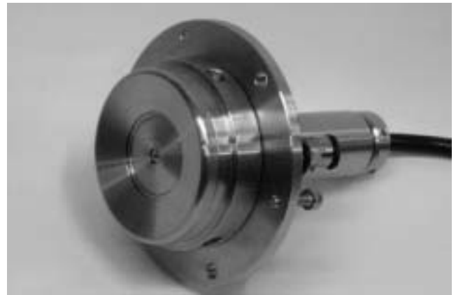
Photo. 2 Air-purge-type electrostatic field sensor. エアパーージ型静電界センサ
