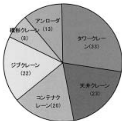
Fig. 1 The amount of the damage to each type of crane クレーンの種類別の被害件数
