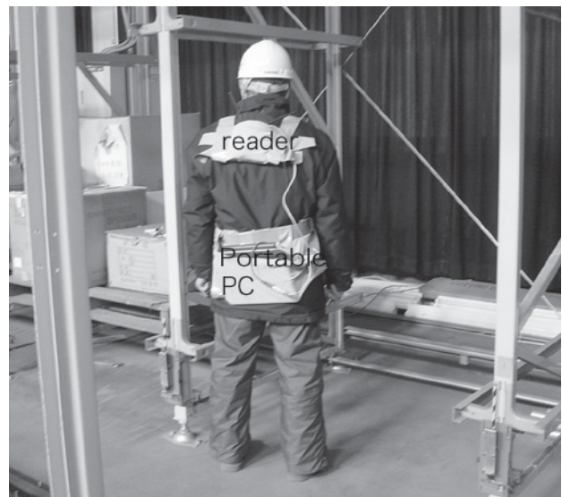
Photo 2 Sensors that a worker carries. 作業者が携帯するセンサー
