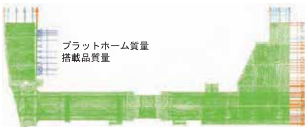
Fig. 6 Finite element mesh of static platform in the 2 nd trial. 静的載荷側の有限要素解析に使用したメッシュ(二次案)
