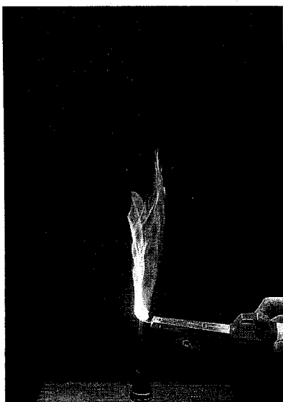
Photo. 6-1 Diffusion burning test for ammonia. 拡散燃焼試験におけるアンモニアの燃焼状況
