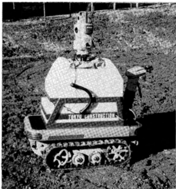
Photo 8 Measuring robot. 測量ロボット
