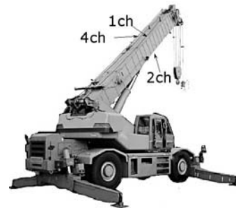
Fig.20 Stain measurement points ひずみの測定点
