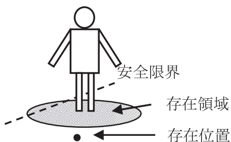
Fig. 1 Failure in detection of object. 位置検出における検出漏れ
