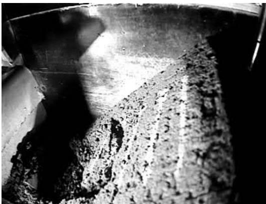
(c) 2.0m 掘削時の部分崩壊
