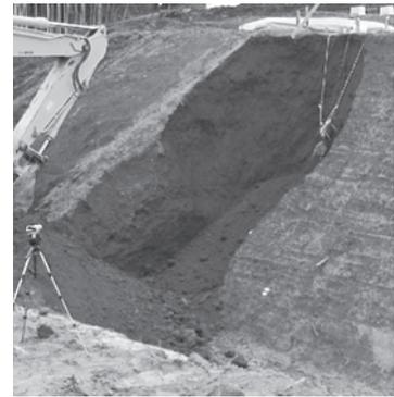
(c) すかし掘りによる完全崩壊
