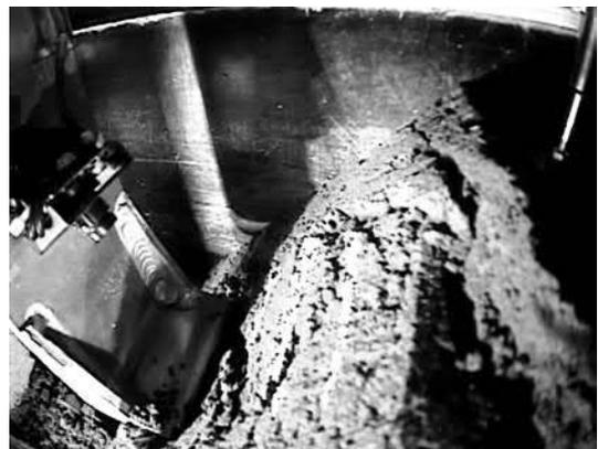
(d) 3.0m 掘削時の崩壊
