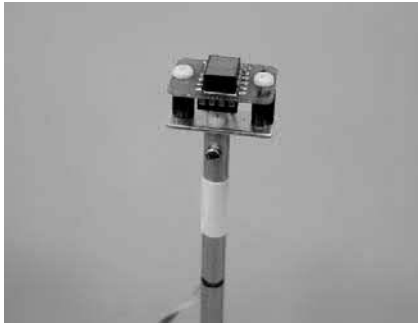
(a) IC パッケージタイプのセンサーエレメント2個をXY 方向に配置した高精度傾斜計
