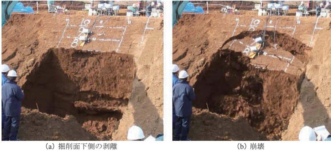
Photo 8 Sequence of slope failure in case F4. ケースF4 (関東ローム・密) の崩壊状況
