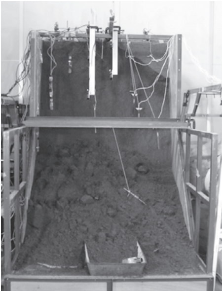
Photo 3 Slope failure in case L3. ケースL3の崩壊状況
