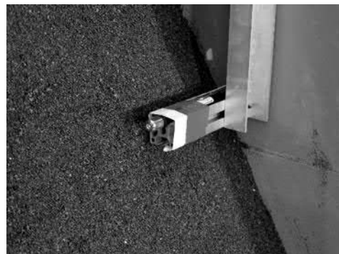
Fig. 20 Pushed out the laser beam by moving slope. 斜面に押されているレーザー光発射部
