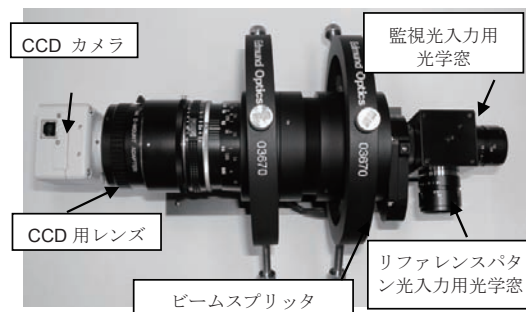
Fig. 19 Optical component of image sensor with beam splitter. ビームスプリッターを使用したカメラ光学部
