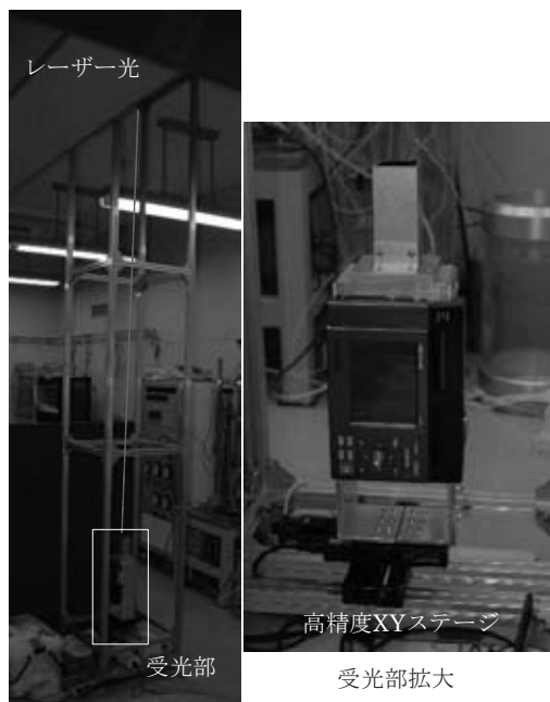
図3 精度検証のためのキャリブレーション試験装置外観
