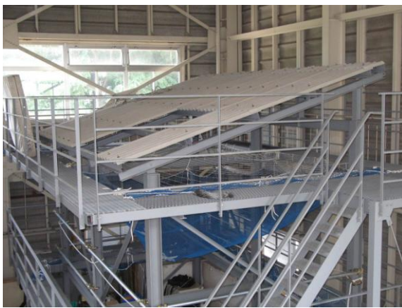
図1 実物大波板スレート屋根試験装置
