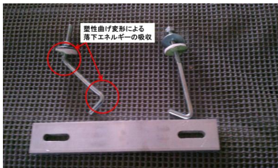
写真6 実験後の親綱取付金具およびフックボルト
