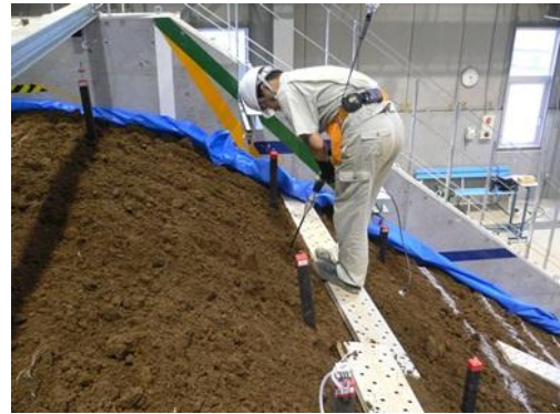
写真1 表層ひずみ棒(MPS)を設置する様子
