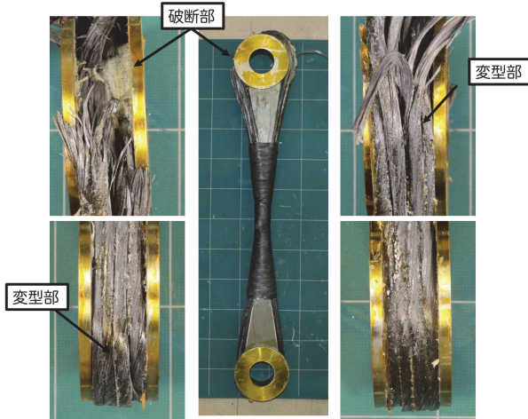
図 10 CF ペンダントの破断後の様子
