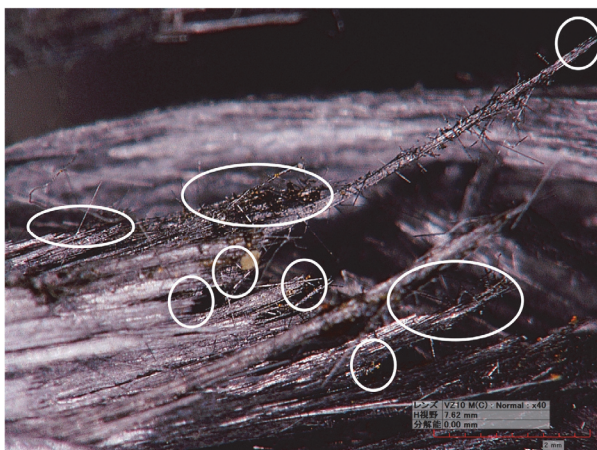
図 15 過荷重により破断した炭素繊維(白丸は炭素繊維の破断部を示す)
