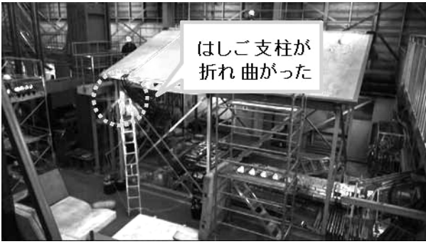
図13 安全ブロックのストラップをはしご支柱の内側を通した場合の実験結果
