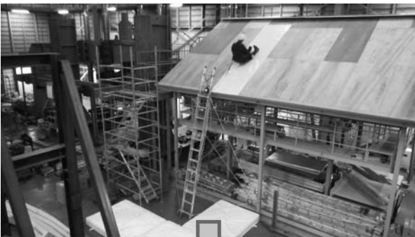
図13 安全ブロックのストラップをはしご支柱の内側を通した場合の実験結果
