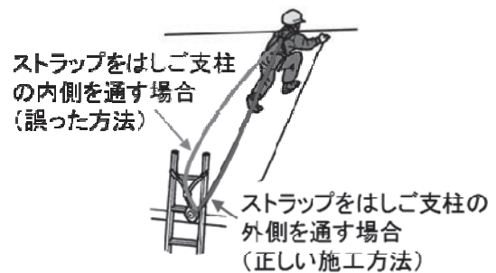
図13 正しい施工方法と間違った施工方法の例 (安全ブロックのストラップの位置)
