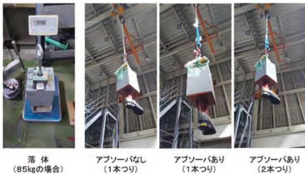
図 8 実験で用いた落体と実験条件
