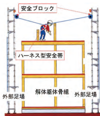
図4 安全ブロックを用いた工法概念図
