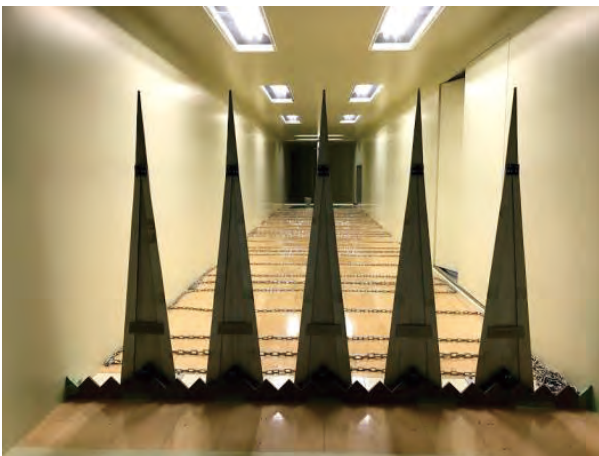
図 9 風洞内に設置されたバリアーとスパイヤー5台
