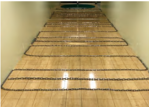
図 10 風洞内に設置された2種類のチェーン
