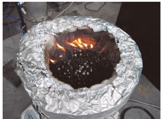
図1 大豆堆積層の下方燃え拡がり実験の様子
