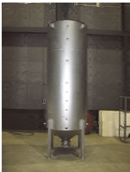
図2 実験に用いた小型タンクの外観 (高さ3.2m, 円筒部長さ2.5m×直径1.0m)
