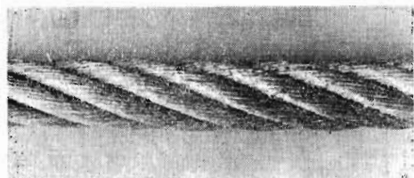
図 2 腐蝕1週間 衝撃試験用端部
