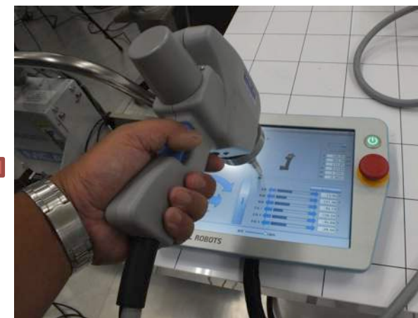
ESDガンによるロボット教示ペンダントへの放電例
