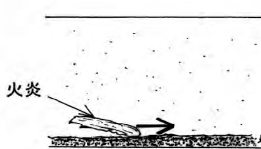
(b) 堆積した粉体層表面に沿った燃え拡がり
